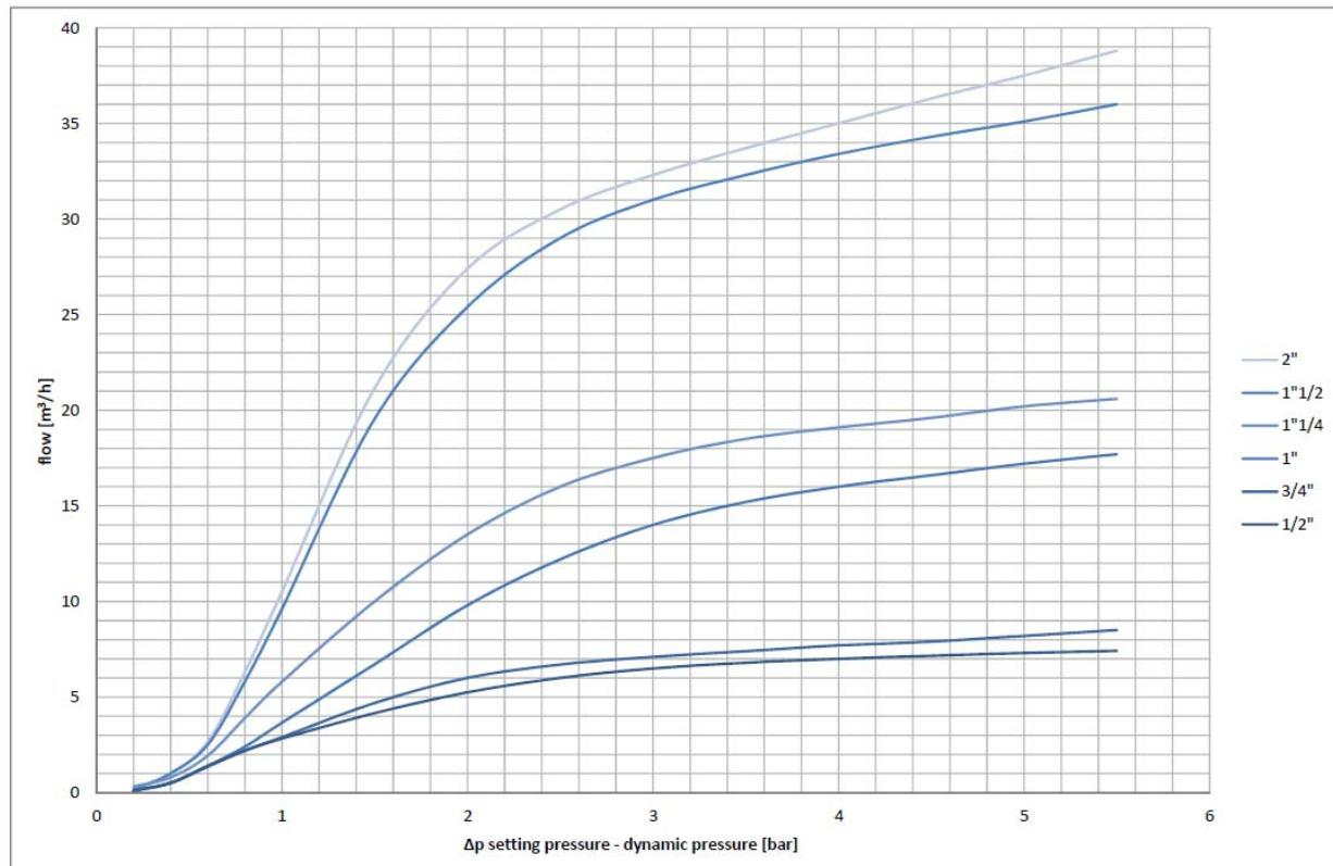
**Lectura del diagrama:** El diagrama de pérdida de carga de la válvula reductora de presión representa la pérdida de presión en función del caudal a la salida de la válvula. / **Reading the diagram:** The pressure drop diagram of pressure reducer valve represents the pressure drop depending on the flow rate in the valve outlet.
